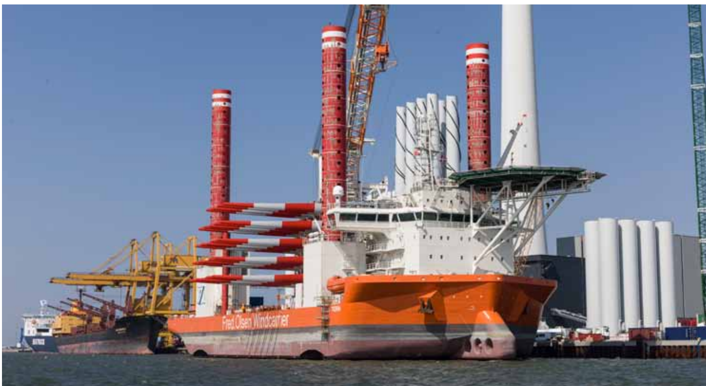
April: Installationsskibet Bold Tern fra Fred. Olsen Windcarrier er lastet med møller ved Østhavnen.
