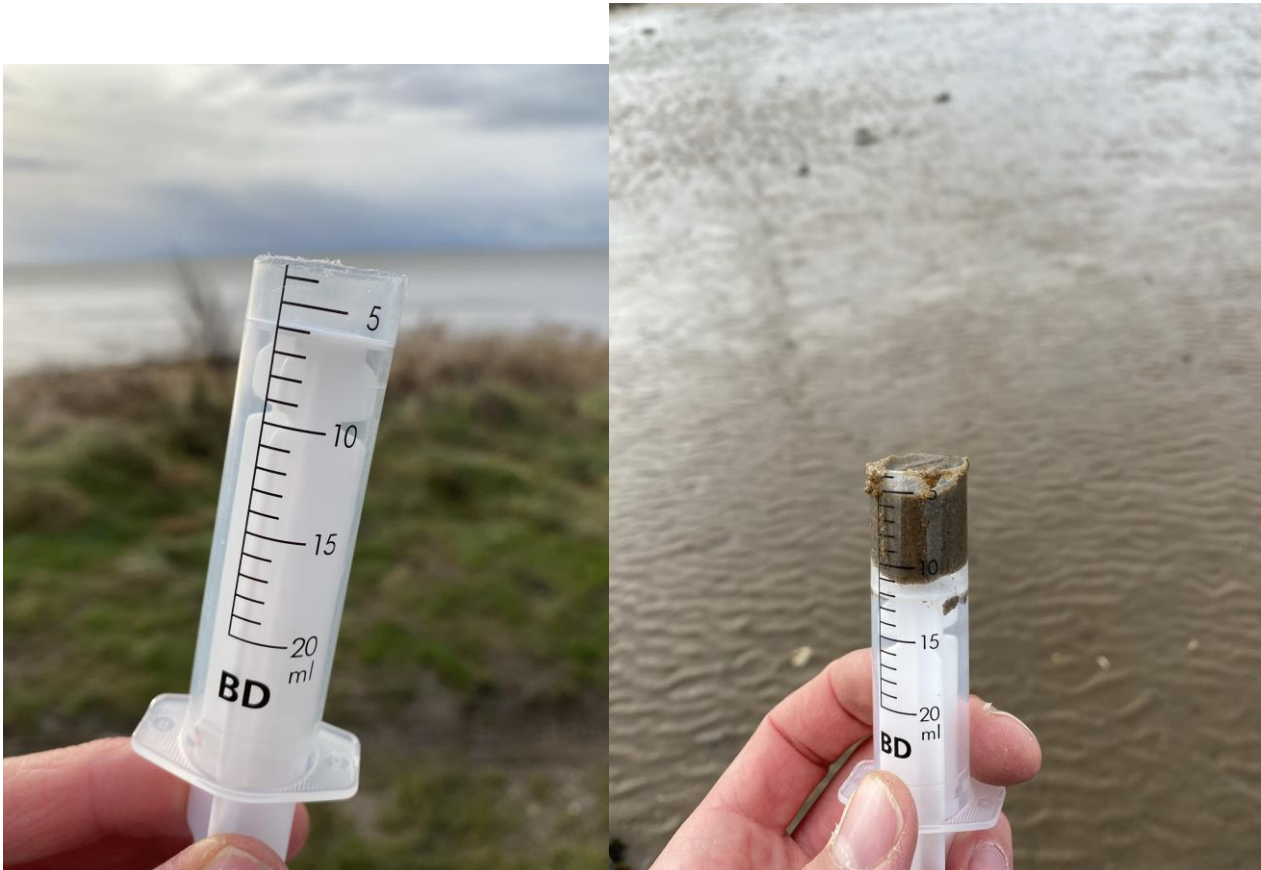
Figur 3.2: Sprøjte til prøveudtagning. Sprøjten stikkes 2 cm ned i sedimentet ved prøvetagning. Derefter presses prøven ud ned i spanden vha stemplet
